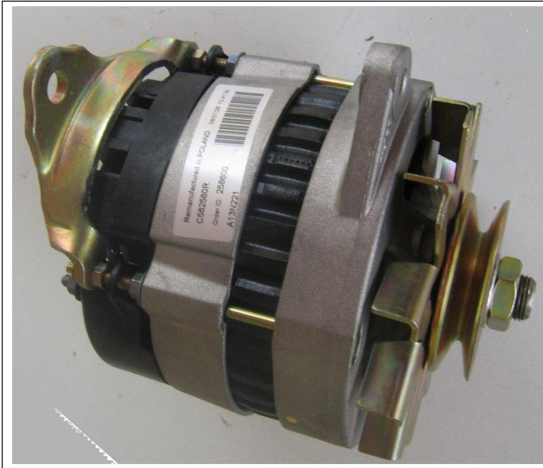
Montage de l'alternateur sur le moteur. Fixation de celui-ci par une vis M10 x 160 (vis d'origine trop courte). Utilisation du bras de tension d'origine ? Sinon pièce à fabriquer proche de celle d'origine.
