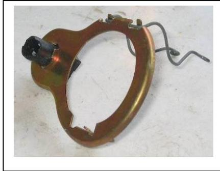
→ Deux supports d'ampoule pour mettre des ampoules 2 filaments, 5W veilleuse 21W stop. La Ste RENEL par exemple distribue ce type de support.
