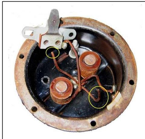
Puis souder ensemble le + de la bobine 1 avec la masse de la bobine 2
