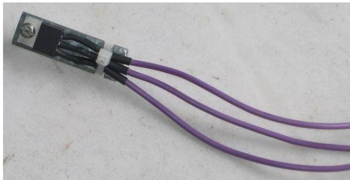
Débrancher l'alimentation (après contacts) sur le vu-mètre de niveau d'essence. Alimenter le régulateur 7806 en 12V (après contact), brancher la masse et raccorder la sortie 6V du régulateur sur le vu-mètre de niveau d'essence à la place de l'alimentation débranché plus haut. Le tour est joué la jauge fonctionne normalement.
