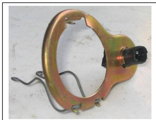
Suivant le diamètre du support d'ampoule sur la parabole du phare cette pièce se monte sans modification. Il suffit de faire un trou pour le passage de la douille de veilleuse et le tour est joué.
